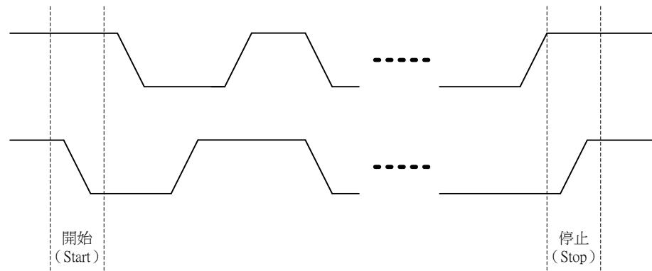
圖 11 通訊 I2C 開始與停止波形
