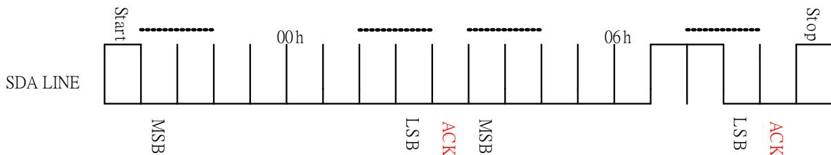
圖 21 通訊 I<sub>2</sub>C 復位晶片
