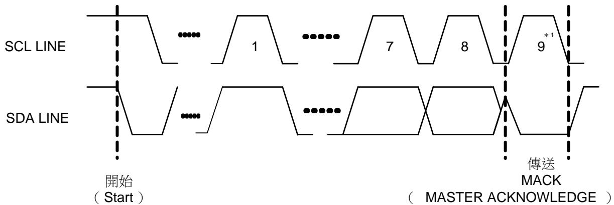
\* 1 MACK發生在讀取Word Address=05h (ADO), 須連續讀取3bytes資料輸出時, 當DATA2/DATA3要輸出資料前, 須在第9個CLOCK上升緣之前, 由主控端(Master)控制SDA為輸出引腳, 設定輸出為Low, 通知從機端(Slave)得以繼續輸出DATA2/DATA3資料.
