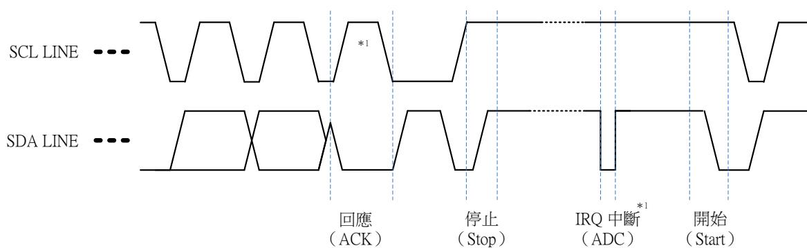
圖 14 通訊 I2C 中斷信號波形 ( IRQ )
