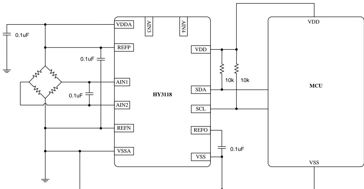
圖 4 橋式感測器應用電路
