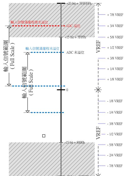
另外，為了因應不同測量的應用輸入信號皆具有零點偏移功能（平移調整）；即是透過改變輸入信號零點的位置，以改善因為傳感器輸入偏移電壓過大而導致最大測量範圍溢出的現象。下圖為一測量訊號取 16-bit( ±15-bit ) 的示意圖，輸入信號未做零點偏移調整時在滿量程部分存在溢位現象，而在做了調整 -1/4 VREF 零點偏移準位後可使得測量信號滿量程時不會發生溢位。
