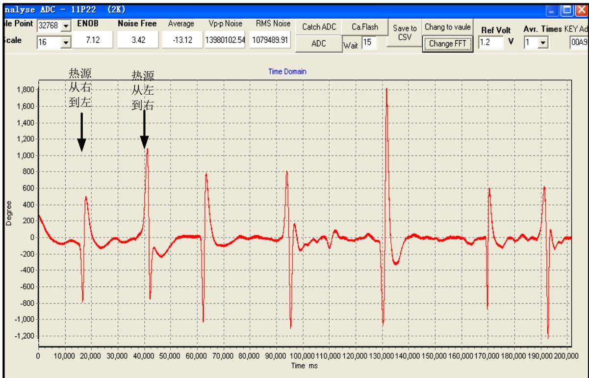
图 3 ADC output 为 1KHZ，凸波为有热源经过时信号
