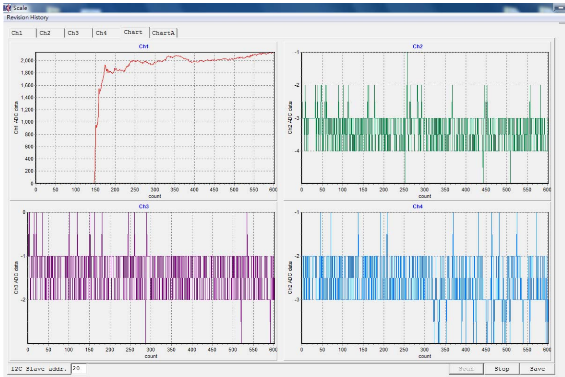
圖 13 在 CH1 放置 100g 砝碼時候的 ADC Raw Data 變化量
