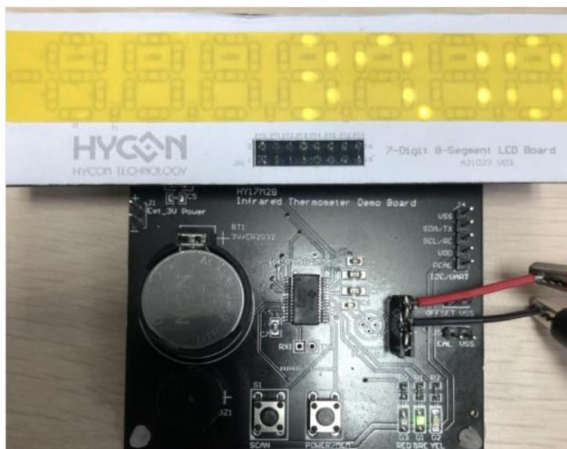
D) 測量過程是亮綠燈，測量完成後，就會蜂鳴器響一下表示測量完成，然後根據溫度值點亮不同的 LED：高溫點亮紅 LED (  $TP > 37.5^{\circ}\text{C}$  )；低溫點亮黃 LED (  $TP < 32^{\circ}\text{C}$  )，正常點亮綠 LED (  $32^{\circ}\text{C} \leq TP \leq 37.5^{\circ}\text{C}$  )。
