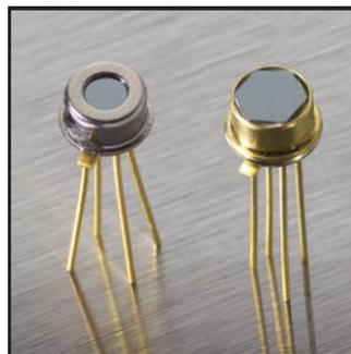
圖 8 PAF9616 紅外線溫度傳感器
