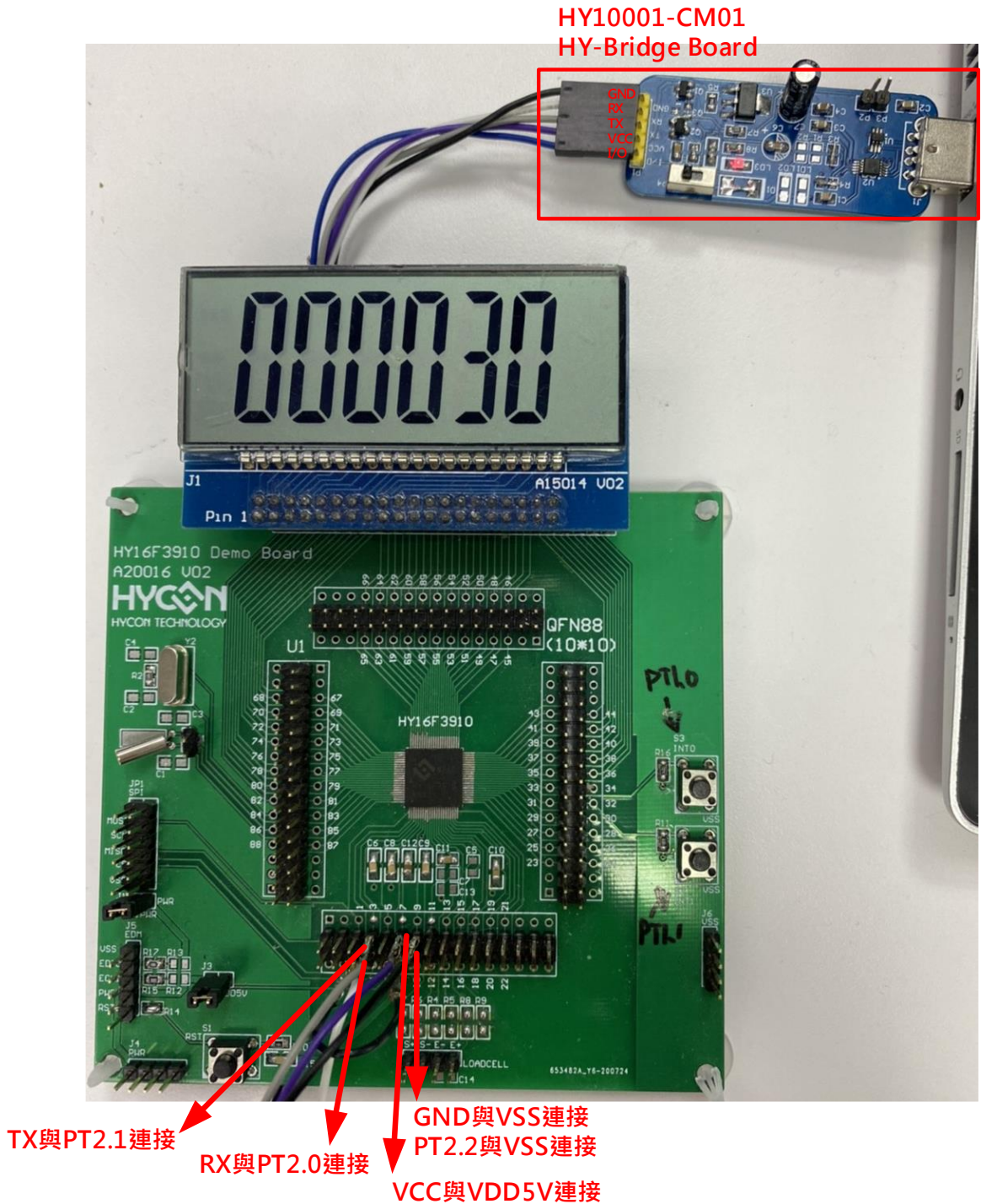
图 15. HY16F3910 硬件连接图示意图(5 线式 UART)
